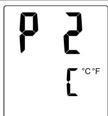
Se visualiza la unidad actual y el valor para la pantalla secundaria parpadea con el fin de indicar que se puede modificar tal valor. Para cambiar el valor de Fahrenheit a Celsius y viceversa, debe girarse la perilla de control.
