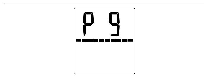
La barra de estado de la capacidad de potencia indica el ajuste de brillo. Una barra a plena capacidad indica que el brillo está en la configuración alta. Una barra a capacidad media indica que el brillo está en el ajuste bajo.
