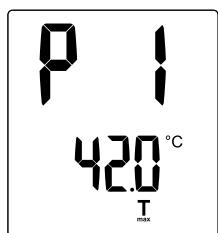
En el menú de ajuste de  $T_{max}$ , la pantalla parpadea, lo que indica que se puede cambiar el valor girando la perilla de control. El valor  $T_{max}$  puede aumentarse girando la perilla de control hacia la derecha y disminuirse girándola hacia la izquierda. El valor  $T_{max}$  puede desactivarse al girar la perilla de control hacia la izquierda, pasando la opción de  $20^{\circ}\text{C}$  ( $68^{\circ}\text{F}$ ). En la pantalla se indicará "Off" si el valor  $T_{max}$  está inactivo.
